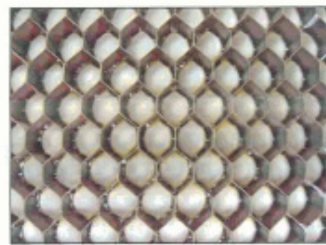
Verbesserter Schallschutz: Motorgehäuse mit Wabenstruktur und eingeklebten Kapseln aus Verbundwerkstoff Foto: Hexcel
