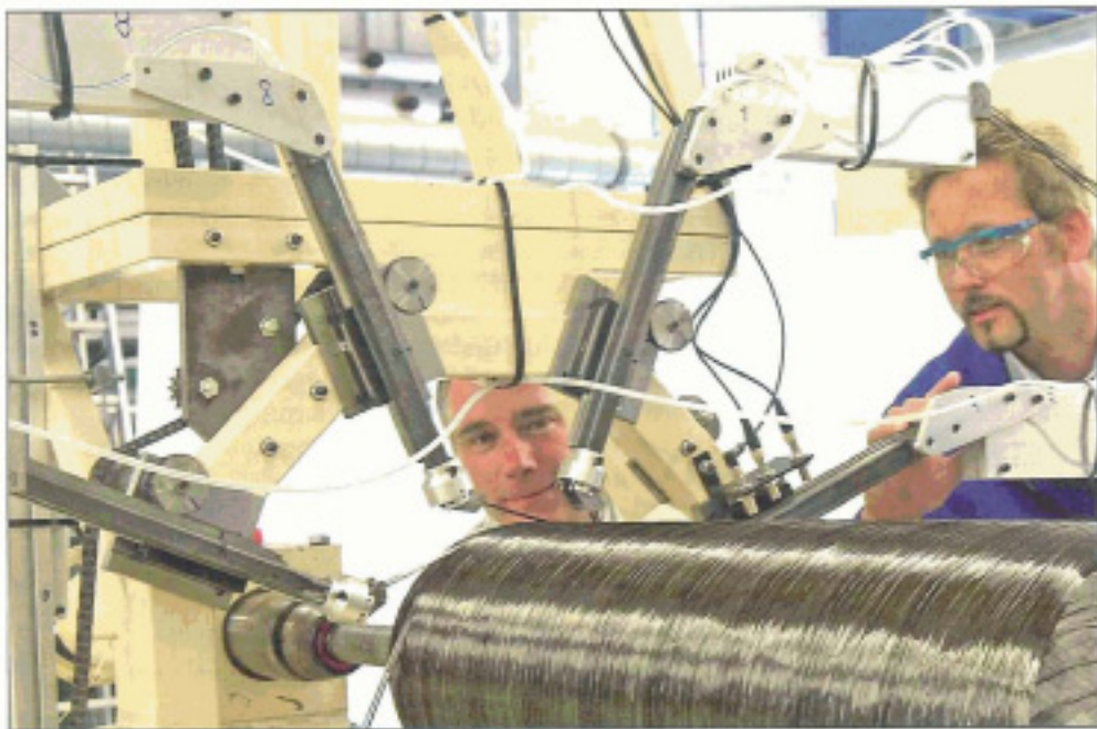
Ringwickelkopf mit modularen Siphon-Imprägniereinheiten in der Druckbehälterfertigung Foto: IVW Kaiserslautern
